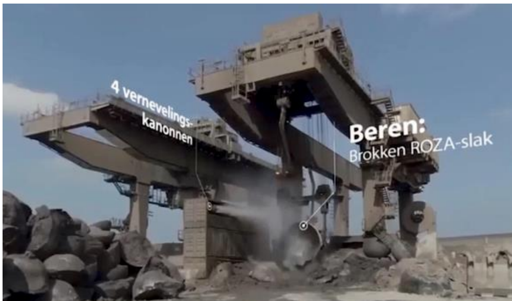
Figuur 4.3 Kiepen van ROZA-slak (bron: Tata Steel)
