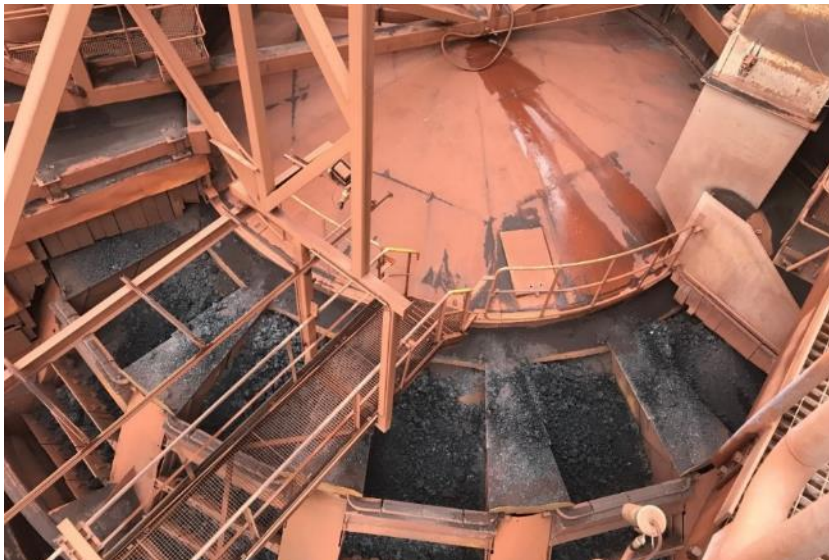
Figuur 4.7 Een sinterkoeler (bron: Tata Steel)
